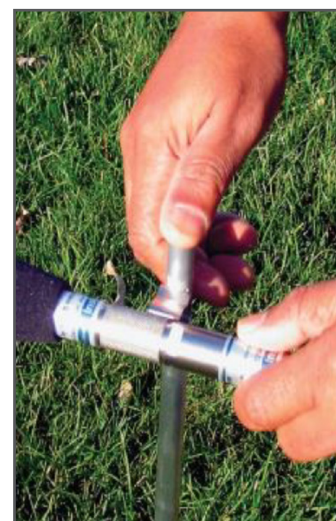
Figure 4. Installation de microphone dans le clip
