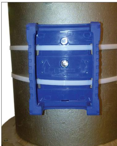
Protection de l'unité du Micromate fixée avec des attaches à tête d'équerre
