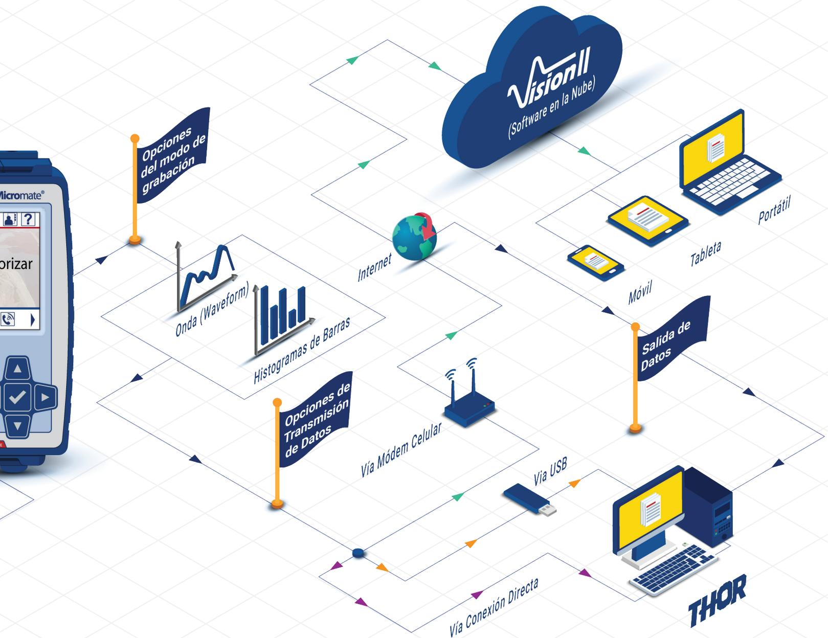
Los sensores geófonos y micrófonos de Micromate capturan todas las vibraciones relevantes de una gran cantidad de aplicaciones industriales. Usando el modo de forma de onda, el de histograma, o una combinación de ambos, el Micromate reúne los datos del evento y luego los transmite a una computadora o dispositivo móvil a través de una conexión directa, USB o módem celular vía internet.
