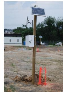
6. La ubicación del geófono de sondeo claramente indicada y el monitor colocado en una caja de enclavamiento segura.
