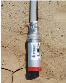
1. Prepare el geófono de sondeo envolviendo las conexiones con cinta eléctrica para mantenerlas limpias.
