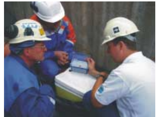
At Salmisaari, Tommi Salomaa, Eino Lehtola and Supervisor Esa Kuikka set up an Instantel MiniMate Plus monitor.
